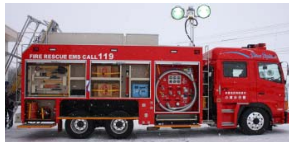
△両側面のシャッターが開き、消防活動に必要な機材が収納されています。
