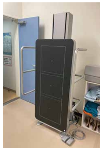
長尺(全脊椎)全下肢専用の撮影装置も導入 しました。昇降式で手すりも設置されており、 患者様への負担が少なくなっています。
