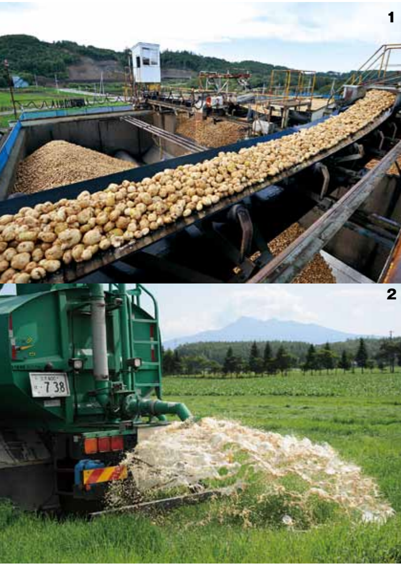
1. 町内の生産者がトラックで納品するじゃがいもは不純物を取り除き、洗浄を繰り返したのちいでんぶん精製工程へと運ばれる。 2. NKゆう水の散布は6台のタンクローリー車で行われる。90日間にわたり、14地区・合計2500haに散布される。
